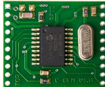
Das RFID-Modul 125kHz von Smart Technologies wurde zur Integration in Terminals oder Handlesegeräte konzipiert.
